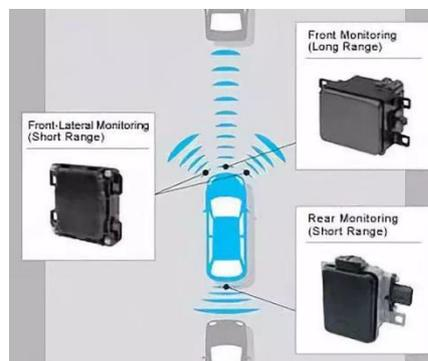
图 4 毫米波雷达应用配置示例
