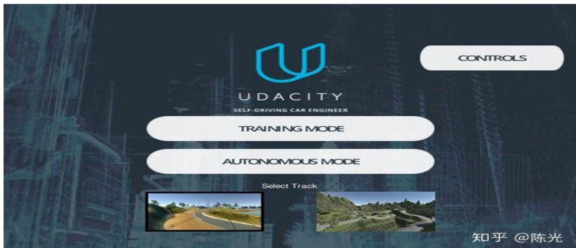
训练模式也可以理解为数据采集模式。点击图中的记录按钮，使用上下左右按键即可实现汽车的行驶，控制汽车行驶一段路，再次点击后，模拟器就会将刚才人工驾驶的这段路的数据进行记录，并存储。
