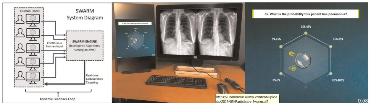
图 2 斯坦福医学院的 swarm 平台。平台的系统图（左图）显示了与网络用户的连接。群体引擎算法在人类做出决策时接收来自人类的连续输入，并向人类提供实时协作反馈，以创建动态反馈回路。
