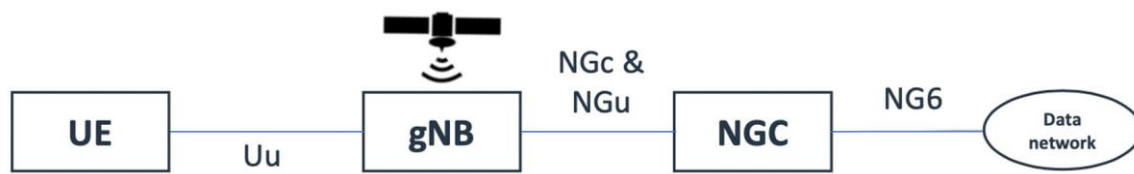
图 3：基于带有星载 gNB 的卫星/航天器，NTN 具有为 UE 提供服务的接入网
