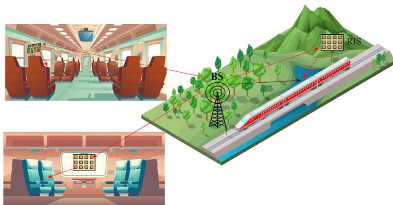
图 4 基于 RIS 的高速移动网络架构图
