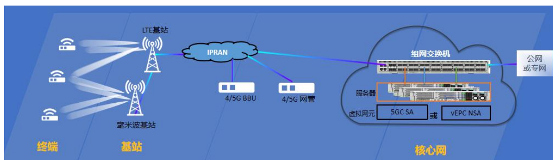
图3 组网架构示意图
